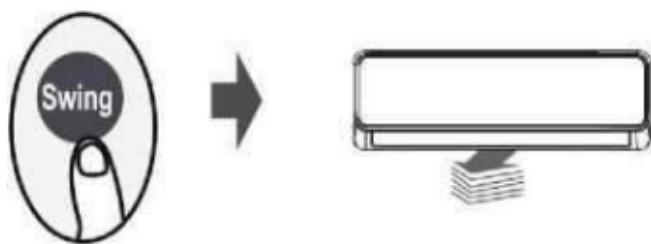
Ako nastavite притискати tipku SWING могуће је одабрати пет смерова протока зрака. Sa svakim притиском на tipku, zaklopka se može kretati u određenom rasponu. Pritisnite tipku dok ne odaberete željeni smer.
