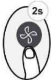
Držite pritisnutu FAN tipku duže od 2 sekunde kako biste aktivirali/deaktivirali **Silence** funkciju (neke jedinice). Zbog niske učestalosti rada kompresora, to može rezultirati u nedovoljnem kapacitetu hlađenja i grejanja. Pritiskom na tipku ON/OFF, Mode, Sleep, Turbo ili Clean tokom rada i Silence funkcija će biti deaktivirana.
