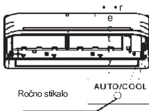
**OPOMBA:** Napravo morate pred uporabo ročnega stikala izklopiti. Če je naprava vklopljena, pritisnjajte na ročno stikalo, dokler se naprava ne izklopi.
