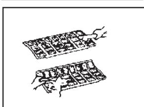
3. Izvadite mali filter osvježivača zraka iz većeg filtera zraka. Očistite ga usisavačem i povremeno ga zamijenite.
