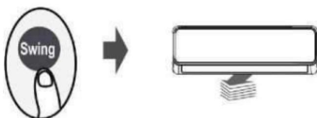
Če še naprej pritiskate gumb SWING, lahko izberete pet smeri pretoka zraka. Z vsakim pritiskom na gumb se lahko loputa premika v določenem obsegu. Pritisnite tipko, dokler ne izberete želene smeri.
