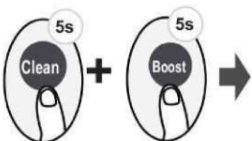
Istovremeno pritisnite tipke Clean i Boost duže od 5 sekundi i tipke će se zaključati. Sve tipke neće reagovati osim ponovnog pritiska na ove dve tipke na dve sekunde kako biste otključali tipke.
