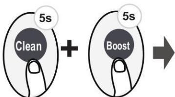
Istovremeno pritisnute tipke Clean i Boost duže od 5 sekundi i tipke će se zaključati. Sve tipke neće reagirati osim ponovnog pritiska na ove dvije tipke na dve sekunde kako biste otključali tipke.
