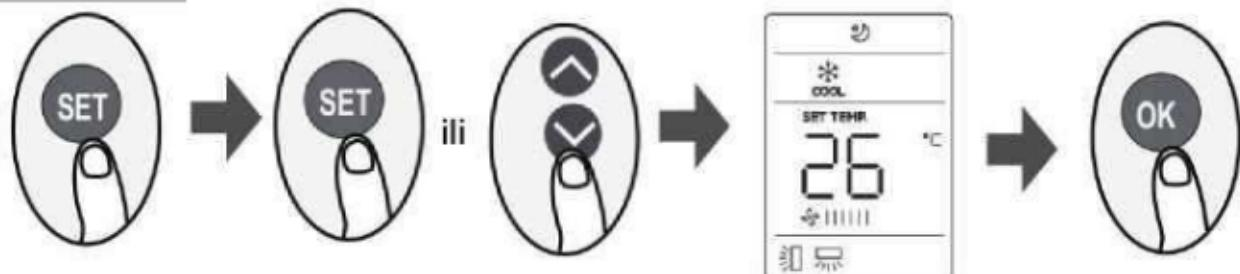
Pritisnite gumb SET za vstop v nastavitev funkcij, nato pritisnite gumb SET ali gumb TEMP  $\wedge$  ali TEMP  $\vee$ , da izberete želeno funkcijo. Izbrani simbol na zaslonu bo utripal in za potrditev pritisnite OK.
