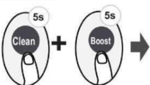
Hkrati pritisnite gumba Clean in Boost za več kot 5 sekund in se bodo gumbi zaklenili. Vsi gumbi se ne bodo odzvali, razen če za dve sekundi znova pritisnete ta dva gumba, da gume odklenete.
