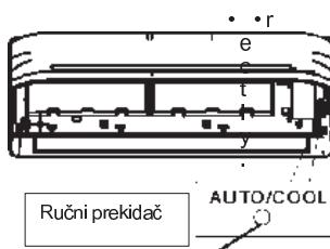
**NAPOMENA:** Uredaj se mora isključiti prije upotrebe ručnog prekidača. Ukoliko je uređaj uključen nastavite pritisakati ručni prekidač do isključenja uređaja.
