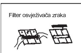
Začepljeni filter zraka smanjuje efikasnost hlađenja ovog uređaja. Molimo Vas čistite filter jednom svaka 2 tjedna.
