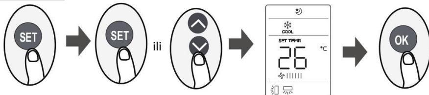
Pritisnite tipku SET za ulazak u podešavanje funkcija, te nakon toga pritisnite tipku SET ili tipku TEMP  $\wedge$  ili TEMP  $\vee$  za odabir željene funkcije. Odabrani simbol na zaslonu će treptati i pritisnite OK za potvrdu.
